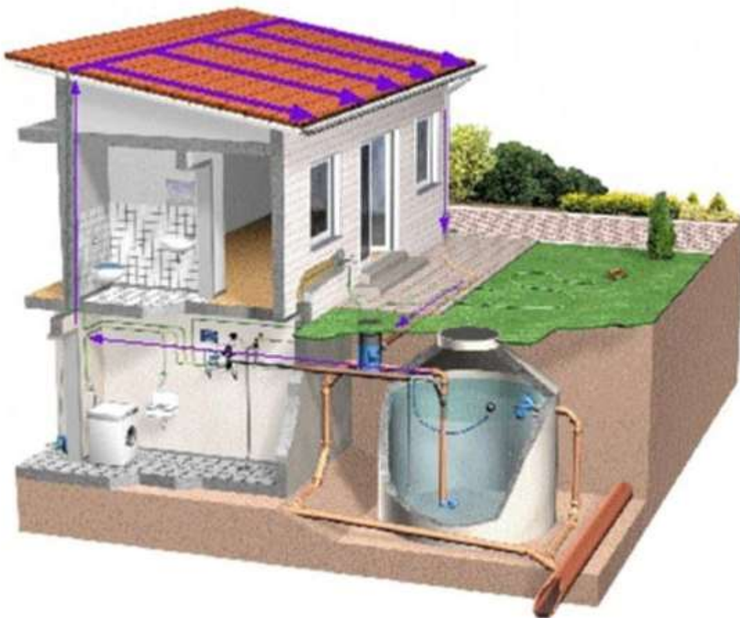
Abbildung 6 Wasserkreislauf einer Dachkühlungsanlage
