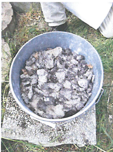
Schlammkekse des auf dem Bodenfilter entwässerter aerob stabilisierten Schlammes nach der Schlamm entnahme von der Beetoberfläche
