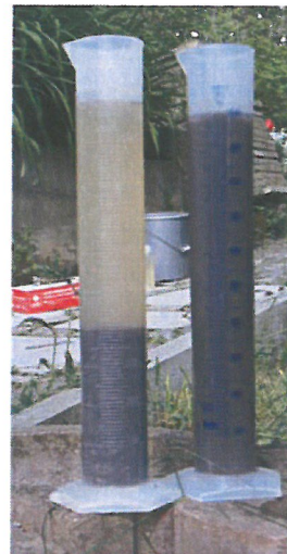
Schlammvolumenmessung links B 1: 400 ml / l rechts B 2: 980 ml / l
