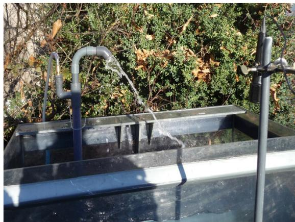
Abbildung 1: Versuchsaufbau ohne Schalldämpfer. Die Tonaufzeichnung erfolgte mit einem Mikrofon (rechts im Bild).
